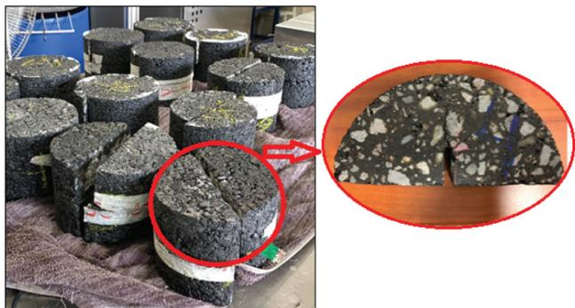
Figura 3. Especímenes ensayo viga semi-circular
