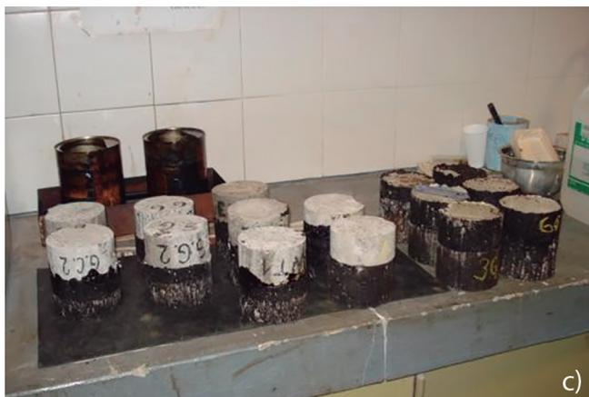
Figura 6. Conformado de probetas de diferente sustrato: a) base de hormigón, b) base asfáltica, c) juego de probetas.
