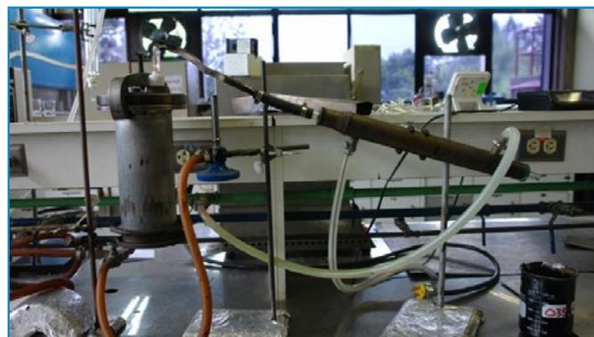
Figura 1. Equipo utilizado en el ensayo de destilación de emulsiones asfálticas
