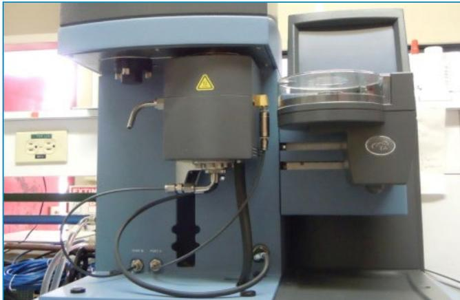
Figura 2. Analizador termogravimétrico (TGA) del LanammeUCR
