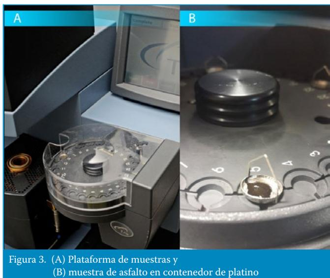
Figura 3. (A) Plataforma de muestras y (B) muestra de asfalto en contenedor de platino
