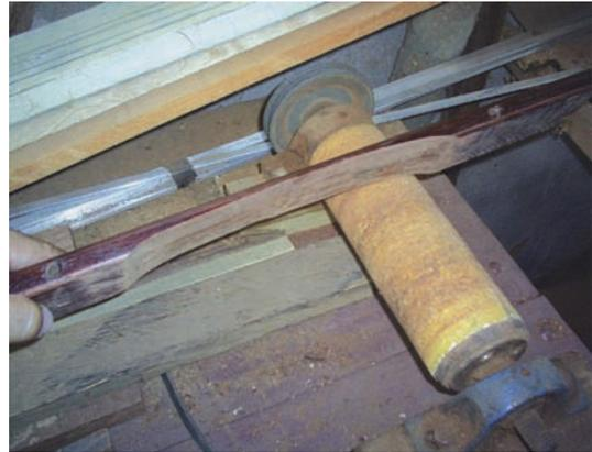
Foto 15: Bolillo cilíndrico para desbastar parte inferior de tecla.
