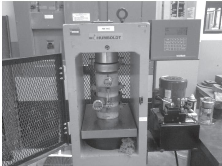
**Figura 5.** Cilindro instrumentado en máquina.
