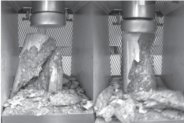
**Figura 6.** Fallas típicas de los cilindros ensayados.
