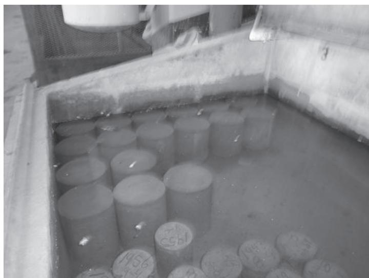
**Figura 4.** Proceso de cura de cilindros.
