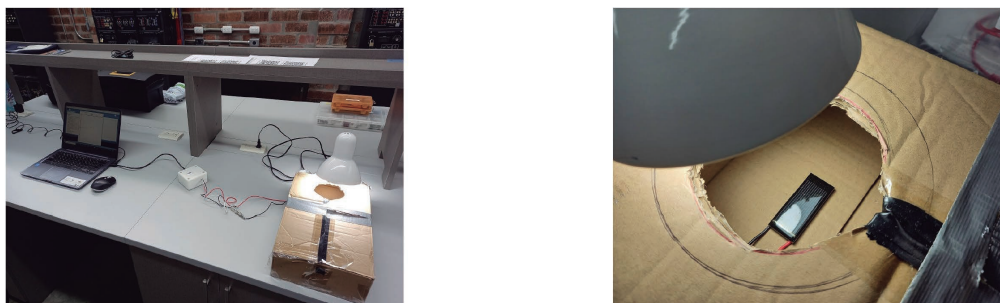
Fig. 3. Fotografías del sistema de prueba utilizado. (a) Sistema completo. (b) Celda fotovoltaica bajo iluminación
