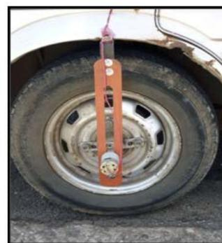
Fig. 2. Montaje de un sistema para medición de velocidad y distancia en carretera. Fuente: Raziel Sanabria.
