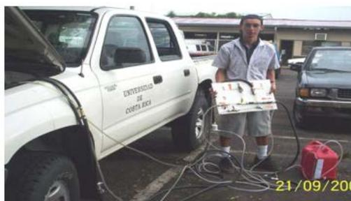
Fig. 1. Montaje para pruebas de consumo de combustible
