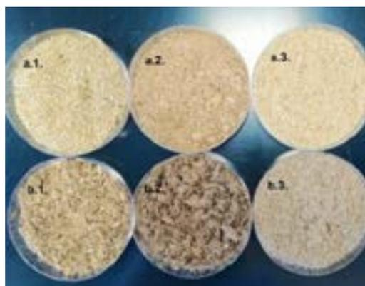
Fig 1. Biomasa lignocelulósica de bagazo de caña (a) y raquis de plátano (b); sin pretratar (1), luego del pretratamiento ácido (2) y posterior al pretratamiento alcalino (3).
