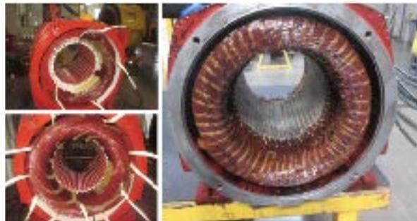
Fig. 4. Condición post reparación/rebobinado.
