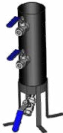
Fig. 1. Tanque de almacenamiento de asfaltos modificados para uso en laboratorio.
