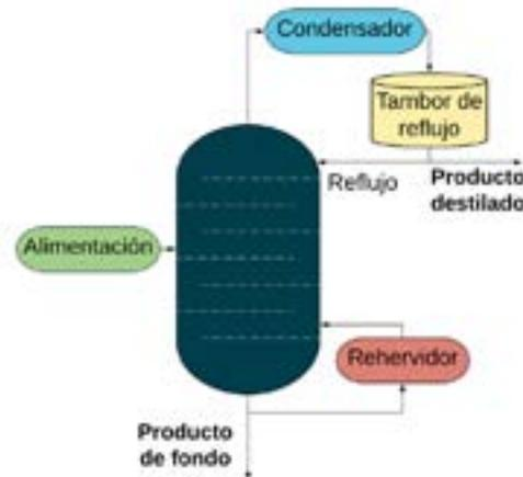
Fig. 1. Columna de destilación.
