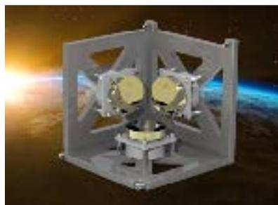
Fig. 2. Vista del sistema de ruedas de reacción en un módulo de CubeSat. (Elaboración Propia).
