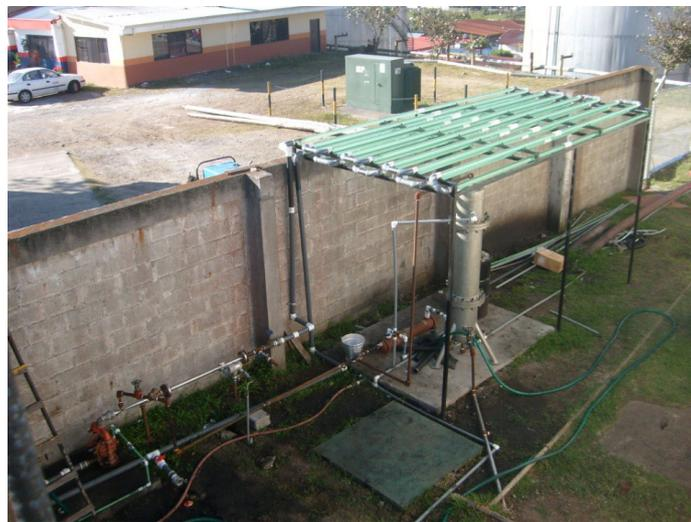
FIGURA 9. Fotobiorreactor tubular y sus servicios.
