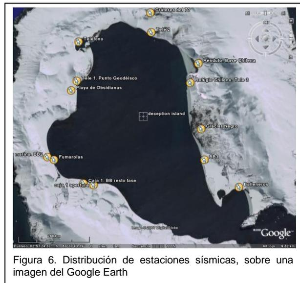
sismógrafos de banda ancha. La Figura 6 muestra cómo se distribuyeron en el perímetro de Puerto Foster.
